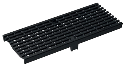
Längsgående galler, segjärn GJS, KTL-behandlad Belastningsklass: D400*, E600* Längd: 50 cm, MW 25 x 11 mm
