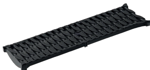
Slitsat galler, OvalGrip Design, komposit, svart Belastningsklass: C250 , Längd: 50 cm, SW 8 mm
