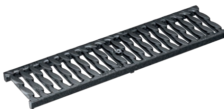
Slitsat galler, OvalGrip Design, seggjärn, KTL-behandlad Belastningsklass: C250, E600*, F900* , Längd: 50 cm, SW 10 mm
