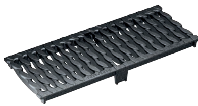
Slitsat galler med OvalGrip Design, segjärn GJS, KTL-behandlad Belastningsklass: D400*, E600* Längd: 50 cm, SW 12 mm
