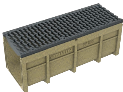
SF-300 ränna med slitsat segjärnsgaller bk. F900 1
