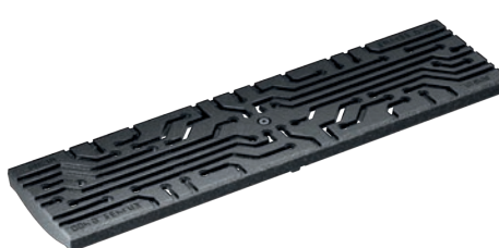
Design galler, WIRE Design, segjärn, KTL-behandlad Belastningsklass: D400* , Längd: 50 cm, SW 5 mm
