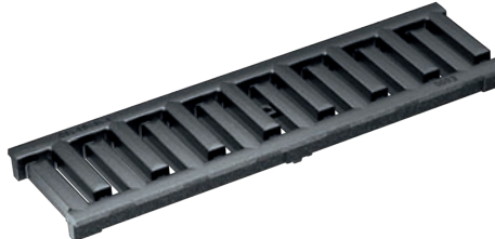
Slitsat galler, MASSIV 32, segjärn, KTL-behandlad Belastningsklass: E600* , Längd: 50 cm, SW 11 mm Passar endast för KE-100.
